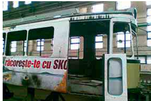
Altes GT4-Fahrzeug, Wagenkasten komplett entfernt
