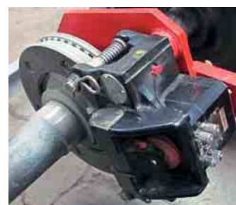
Federspeicherbremssattel HYS 256 Spring-applied brake caliper HYS 256
