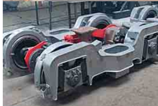
Fahrwerk vor und nach der Überholung Running gear before and after modernization
