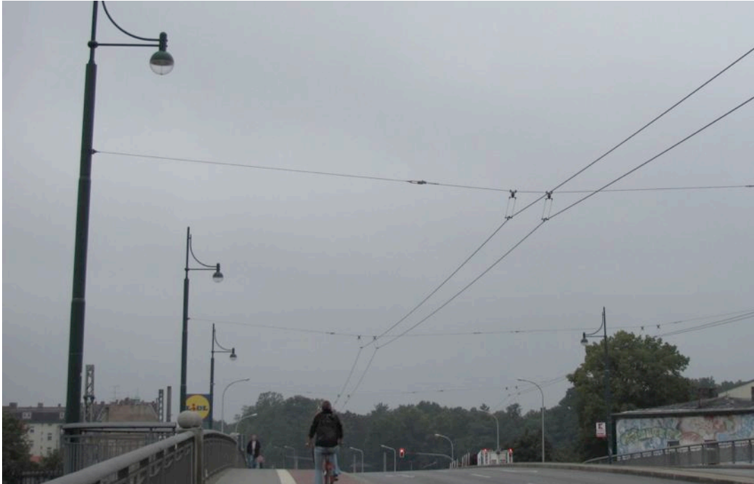
Kuva 3.1-1 Joustavasti kiinnitetty johdinauton ajojohto Eberswaldessa. (Kuva: Raimo Mättö)
