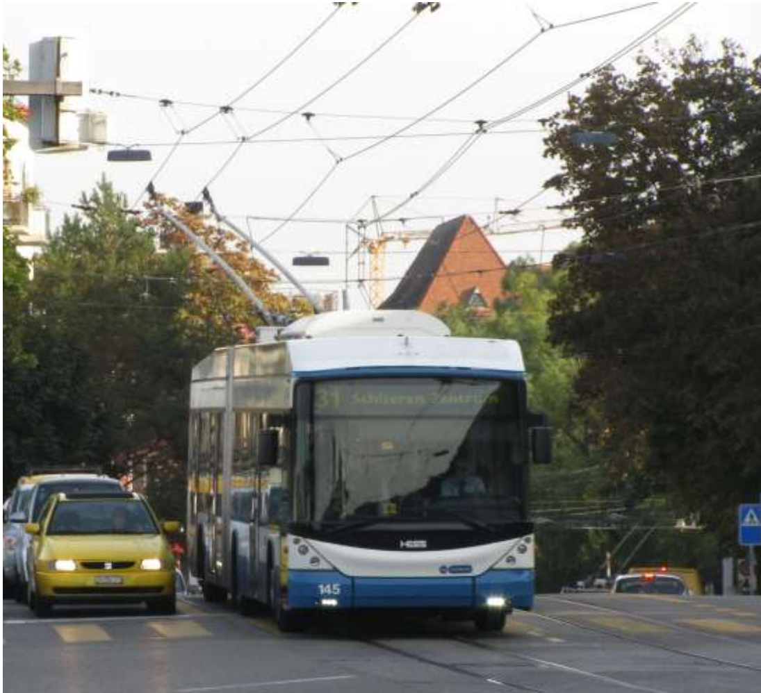
Kuva 13. Johdinauton ja raitiovaunun yläpuoliset ajojohdot Zürichissä. (Kuva Raimo Mättö).
