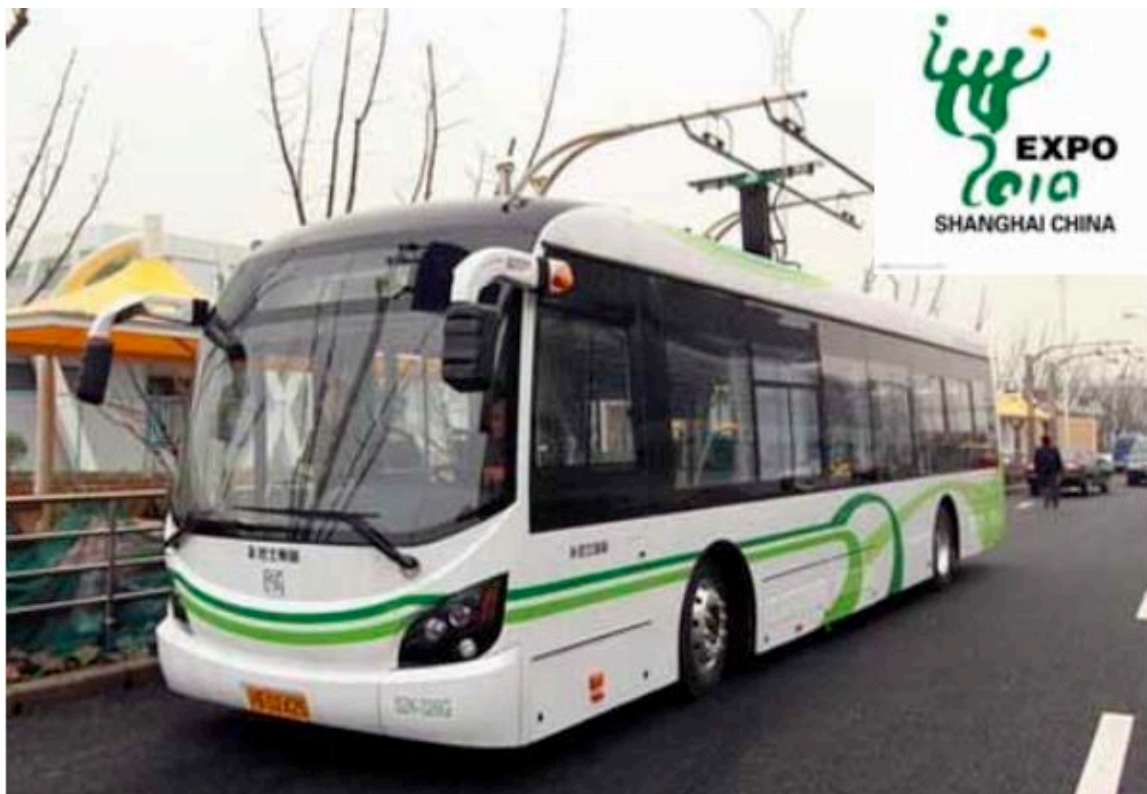
Kuva 2.7. Shanghain Expo2010 superkondensaattorijohdinauto lataamassa pysäkillään. (Kuva: Shanghai Aowe Technology)
