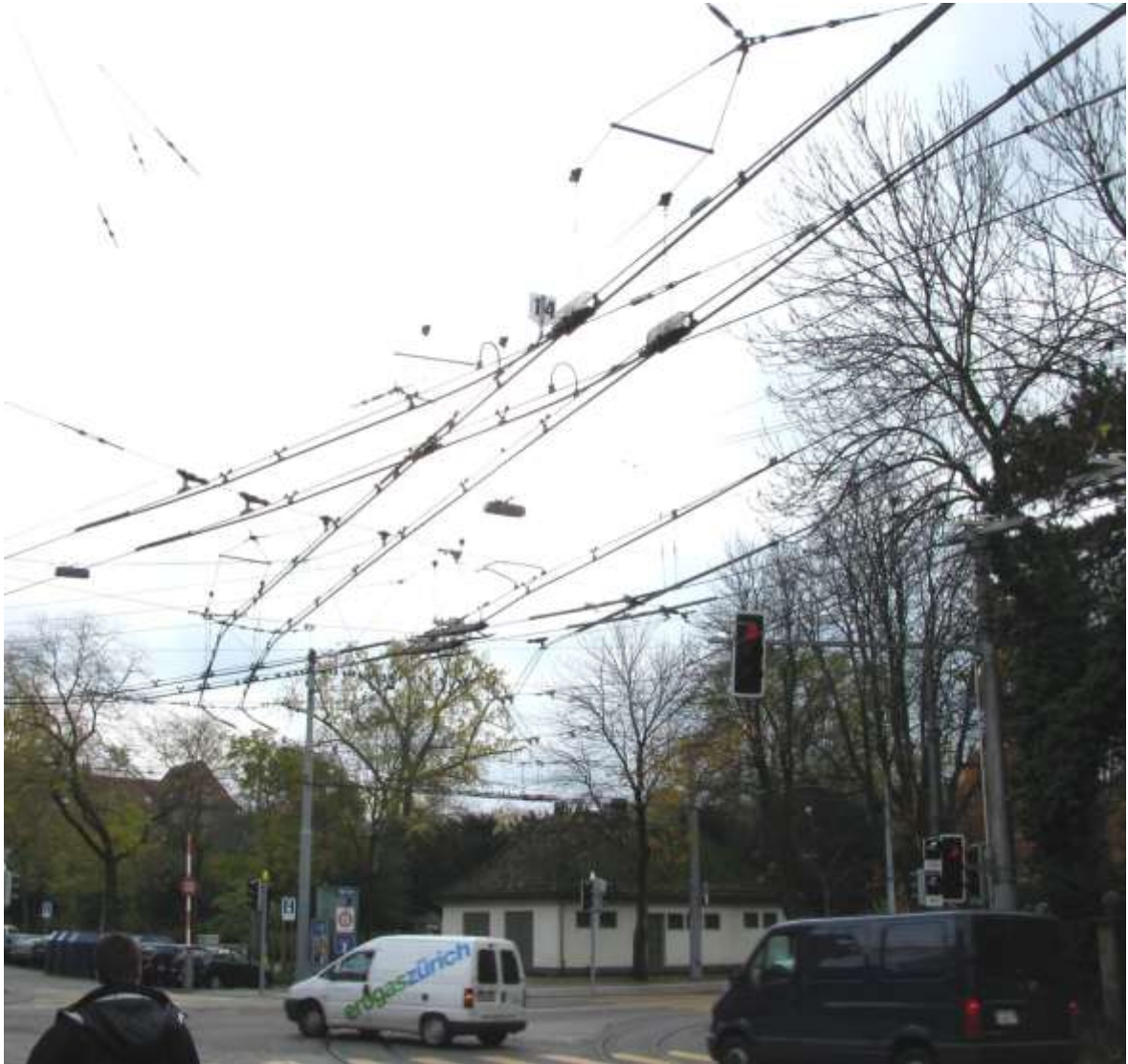
Kuva 16. Johdinauton vastavaihte (linjan haarautuminen kahdeksi), raitiotien ja johdinauton risteys ja johdinautolinjojen risteys. (Kuva Raimo Mättö).
