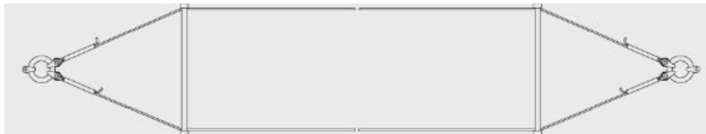
Vaihteen yläpuolelle asennettava tukitrapetsi
