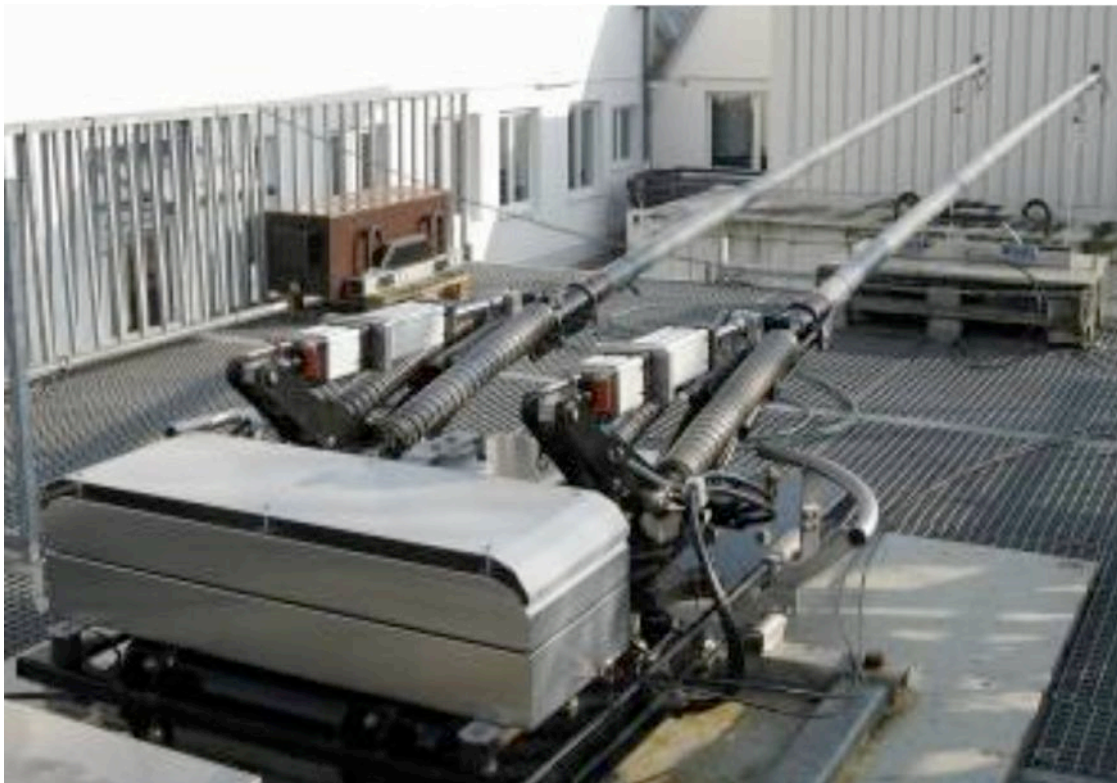
Kuva 2.6.1 Vossloh-Kiepe OSA500-mallinen virroitin jossa on nosto- ja laskuautomaatiikka. (Kuva: Artturi Lähdetie)
