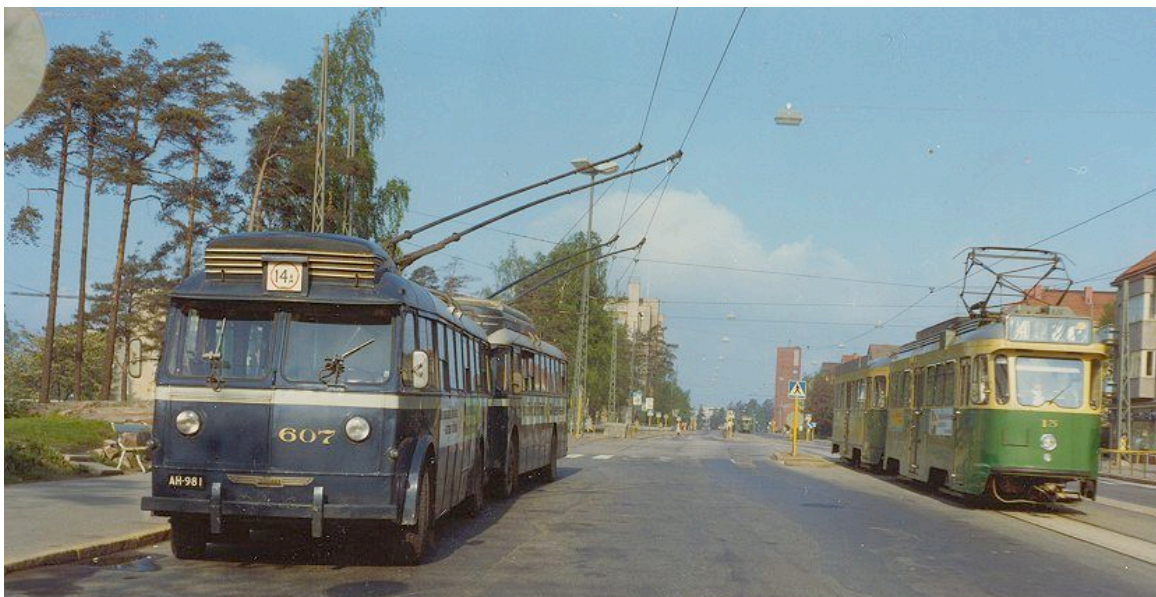
Kuva 3.4-1 Jäykästi ripustettu ajojohtojärjestelmä Helsingissä. Vasemmalla näkyvät johdinauton ajolangat, jotka on ripustettu samalla tavalla kuin raitiovaunun ajolanka. Kuvasta näkyy myös kuinka johdinauto voi väistää viereiselle kaistalle, mutta ei ohittaa toista johdinautoa ilman virroittimen laskua. (Kuva: Juhani Katajisto)
