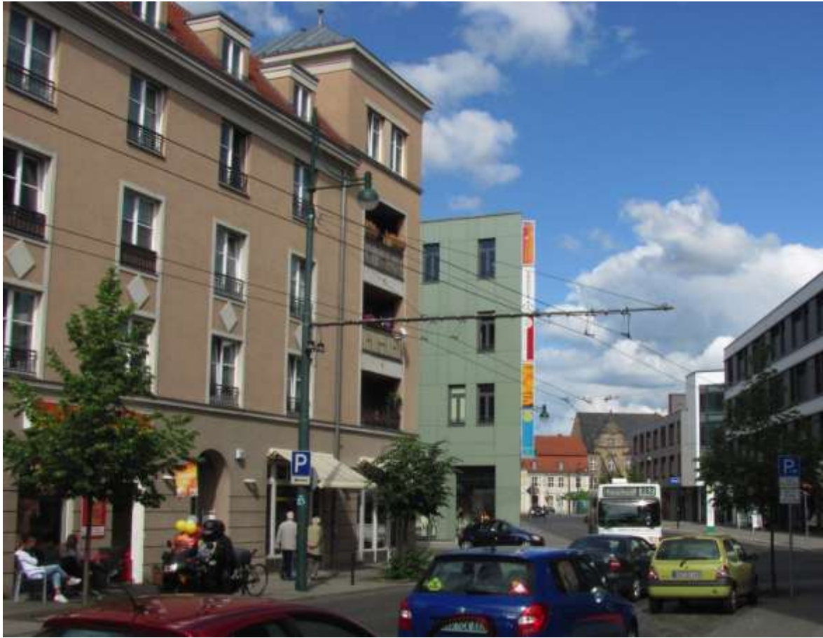
Kuva 15. Yhdistetty valaisin- ja ajojohtopylväs ja kääntöorsiripustus Eberswaldissa. (Kuva Raimo Mättö).
