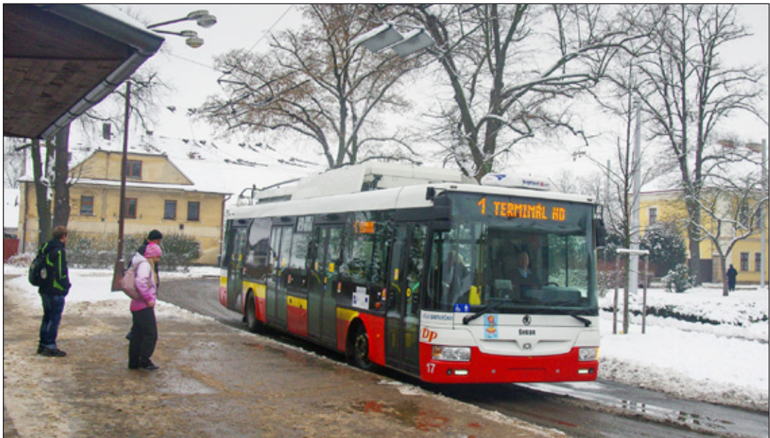
Fig. 5 - Low floor electric-diesel hybrid trolleybus in Hradec Králové
