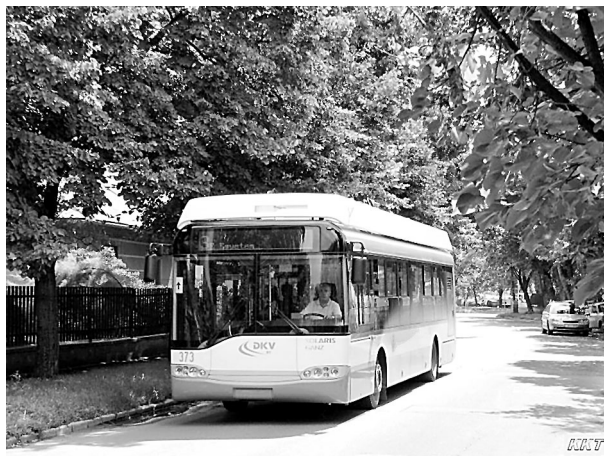
Ryc. 2.3. Trolejbus Solaris Trollino 12D w Debreczynie (Węgry) podczas przejazdu przy zasilaniu z agregatu spalinowego.
