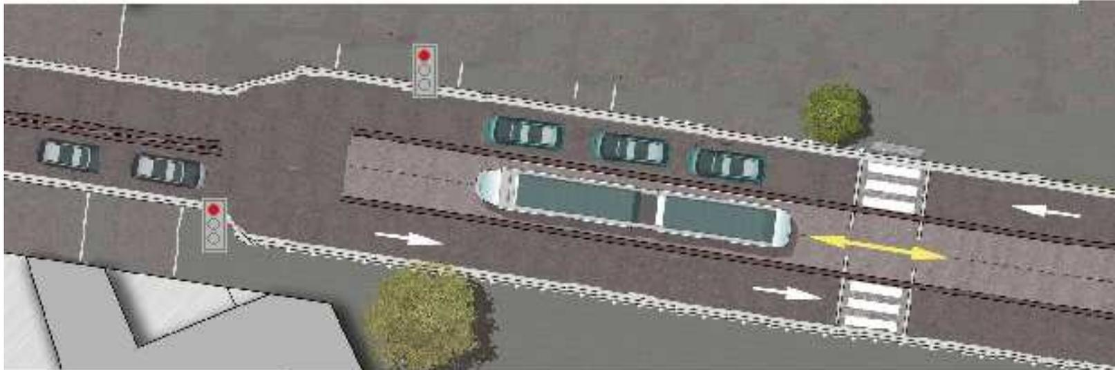
Pour permettre la sortie du tramway de son site réservé, la circulation est arrêtée par des feux tricolores et la circulation est libérée derrière le tramway
