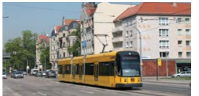
Tramvaj Bombardier NGT D8DD odbočující ve stanici Nürnberger Platz v uličním prostoru, zatímco automobilová doprava je zastavena světelnou signalizací opodál
