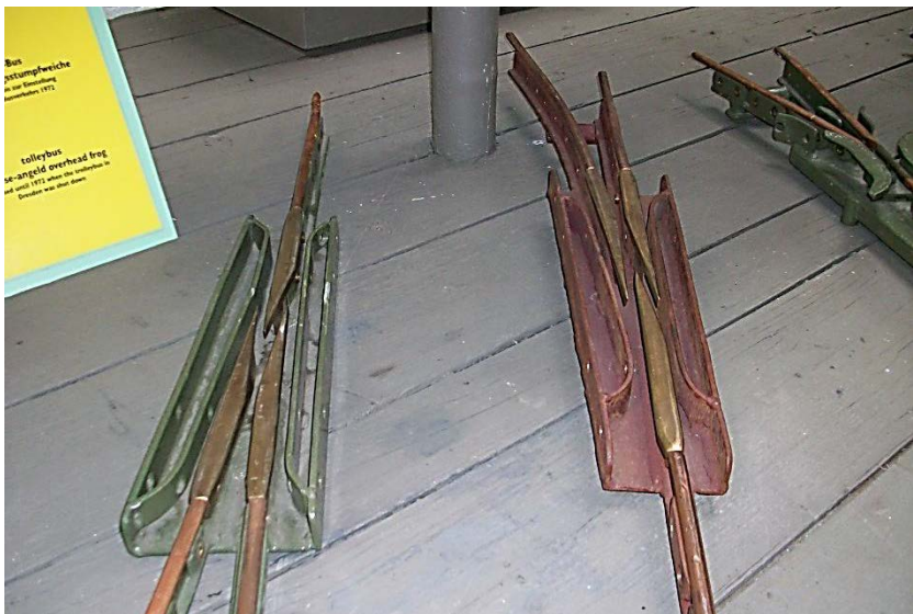
oben: elektrische Obusweiche mit Rückstellfunktion (2 Fotos im Straßenbahnmuseum Dresden) unten: stumpf befahrene Obusweichen
