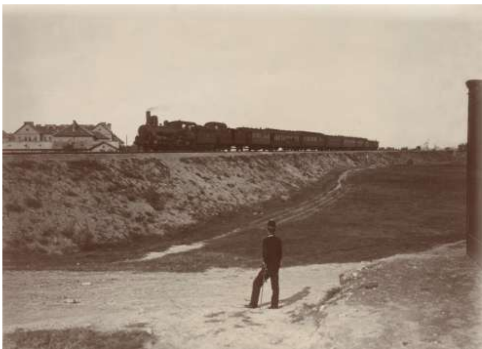
Tren expres la ieșire din gara Timișoara Iosefin, pe noul traseu spre gara Fabric, remorcat de o locomotivă compound seria MAV 222 (cu cilindri dispuși în tandem), în anul 1906 Colecția Valentin Ivănescu
