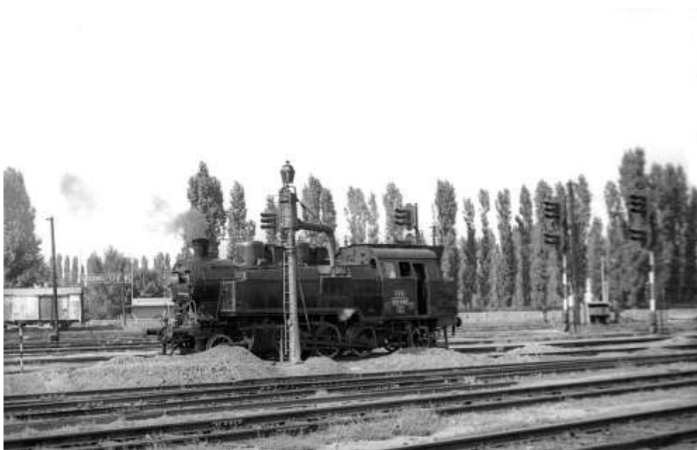
Locomotiva 131.048 utilizată la serviciul de manevră în Timișoara Nord, la alimentare cu apă de la coloana hidraulică din capătul spre Lugoj Foto Detlef Schikorr
