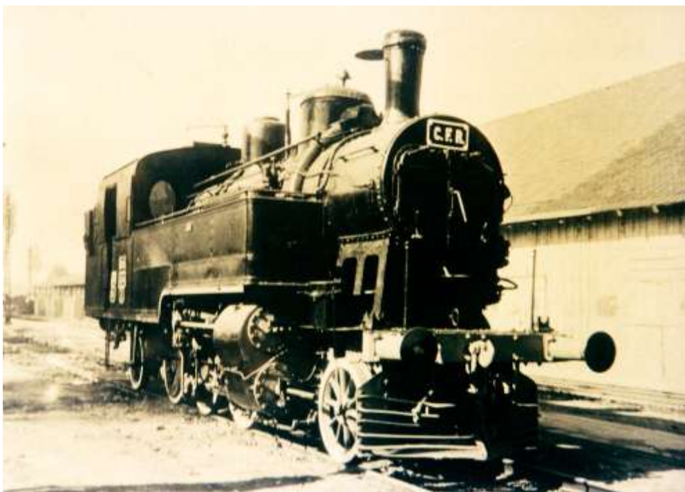
Locomotivă din seria 375 utilizată la remorcarea trenurilor pe liniile de șes din Banat Colecția Silviu Dârlea
