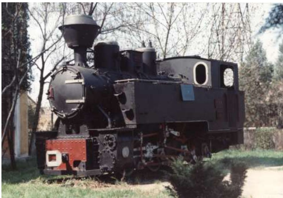
Locomotiva de cale îngustă pentru ecartamentul de 764 mm, tip Dt-n2 construită la Reșița, păstrată în curtea Liceului Feroviar din Timișoara, surprinsă pe peliculă foto în anul 1986
