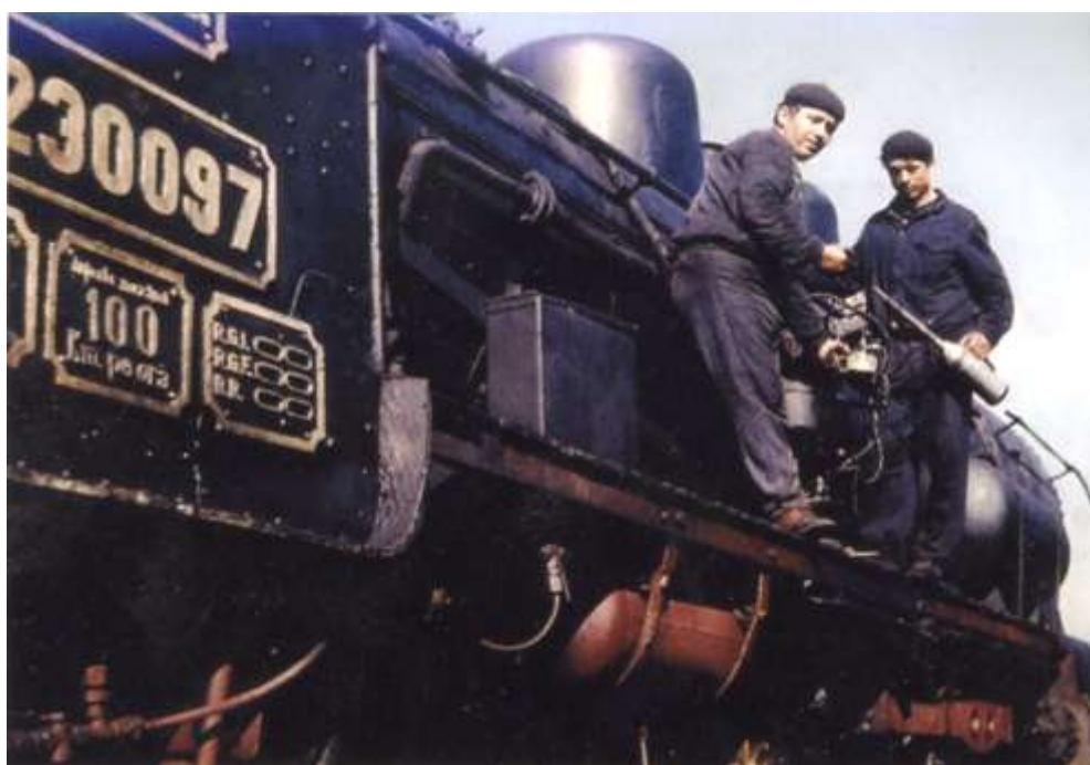
Mecanicul și fochistul completând uleiul la aparatul de uns al pompei de aer Duplex a locomotivei 230.097 în stația Urziceni în anul 1972
