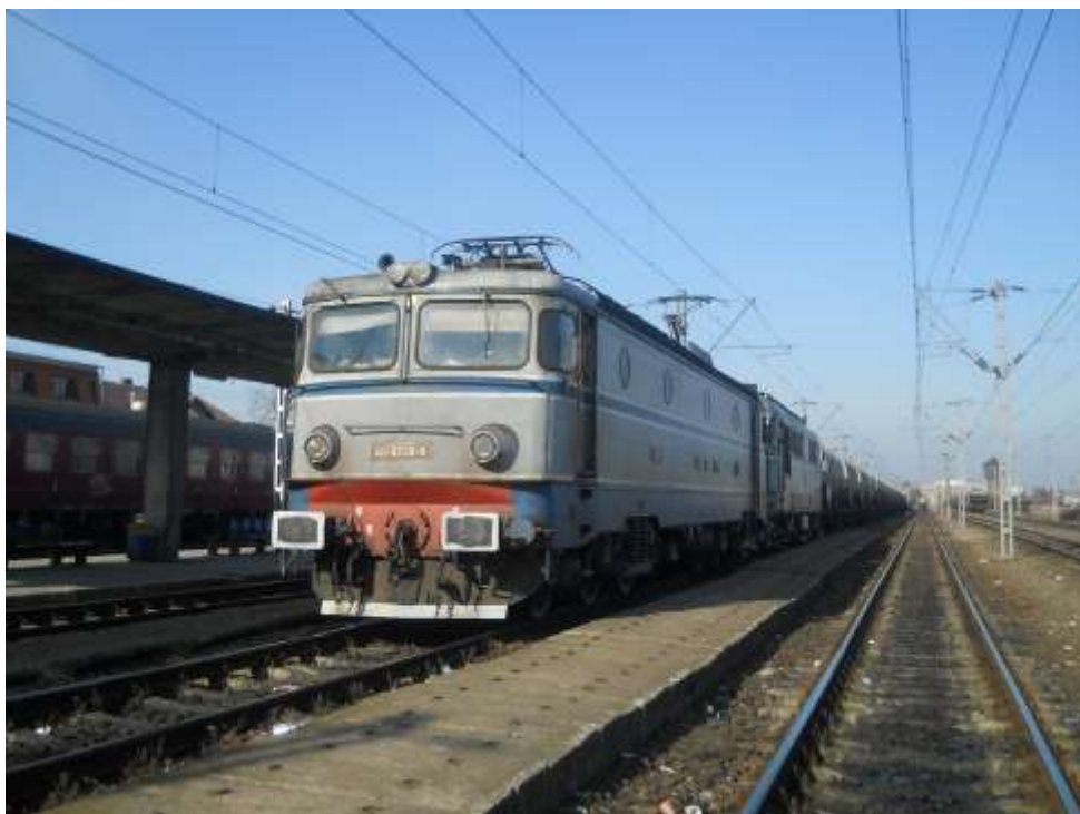
Tren de marfă având în componere vagoane cisternă, remorcat în dublă tracțiune de o locomotivă electrică și de o locomotivă diesel – electrică, în stația Arad, gata de drum spre Simeria în toamna anului 2011
