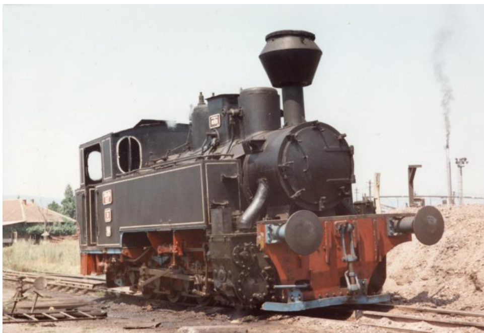
Locomotiva de cale îngust 764.414 echipat cu aparat de trac iune-legare, la manevr în C.P.L. Or tie în vara anului 1990
