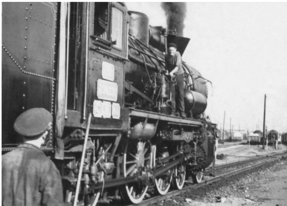
Remedierea unei defecțiuni la pompa de aer la locomotiva 230.231 în 1966
