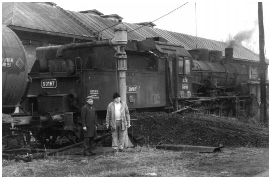
Locomotiva 50.109 utilizat ca generator de abur în Remiza Lugoj în anii '80
