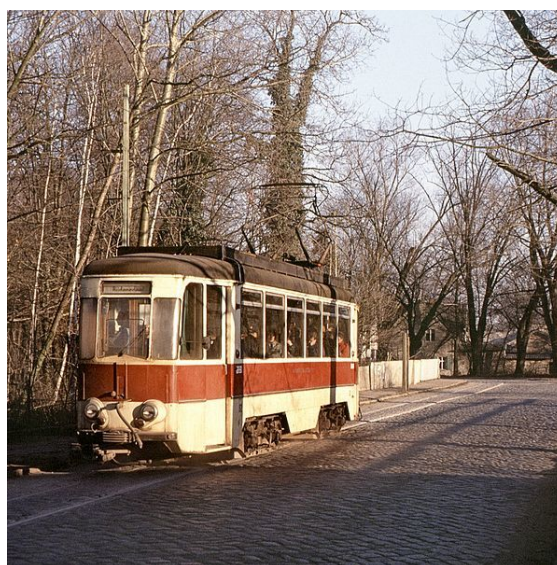
Tw 52 (Umbau 1975 zum Einrichtungswagen aus Tw 2 (Lindner/AEG) von 1914) [5]
