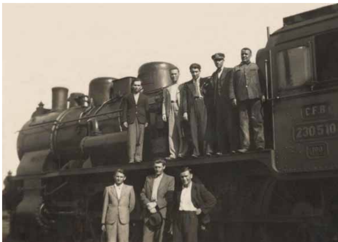
Locomotiva 230.510 construită la Uzinele Reșița echipată cu distribuție Lenz în depoul Arad în 1949 Colecția Mircea Redeuș
