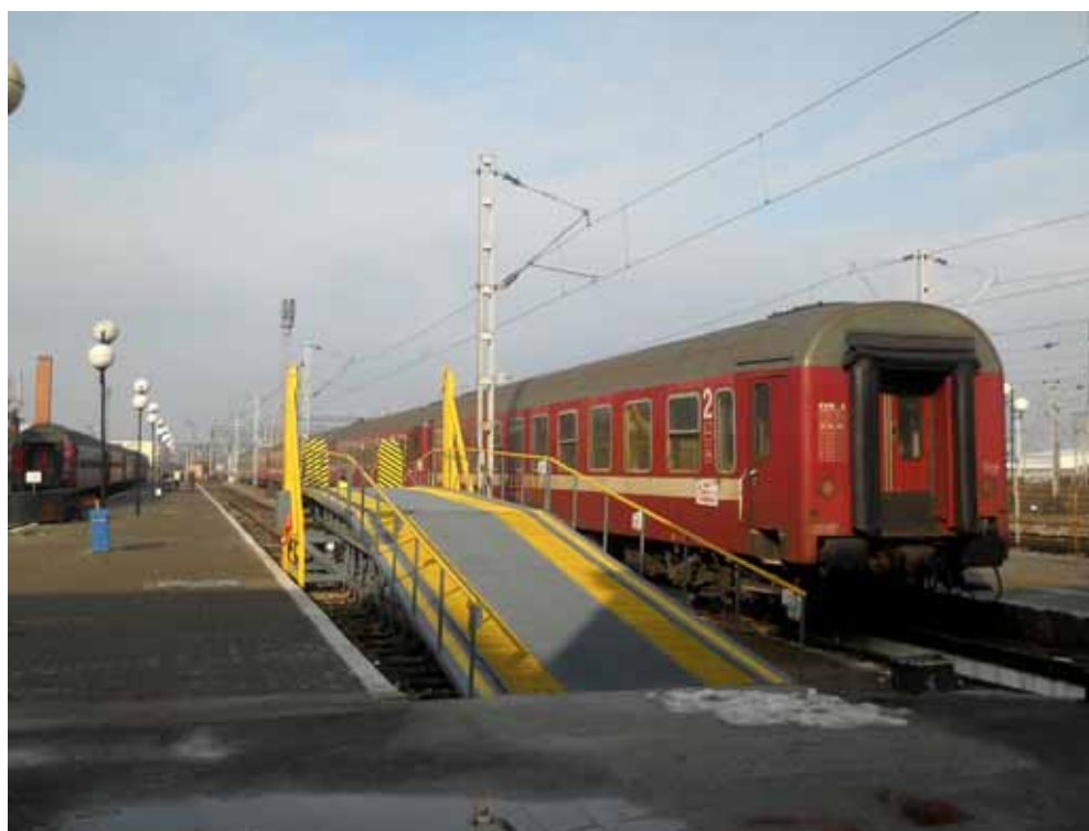
Rampa pentru încărcarea-descărcarea autovehiculelor
