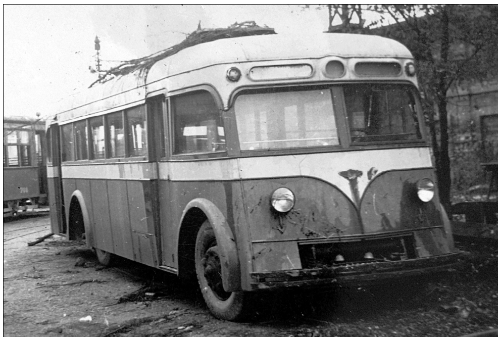
Fig. 2. Troleibuzul ЯТБ–4a la Odessa, 2 noiembrie 1941. Forma casetei de traseu și a acoperișului sunt diferite față de ЯТБ–4, iar geamurile de la parbriz au primit colțuri rotunjite. Se observă lipsa roții exterioare de pe puntea spate. Colecția: SANIC.
