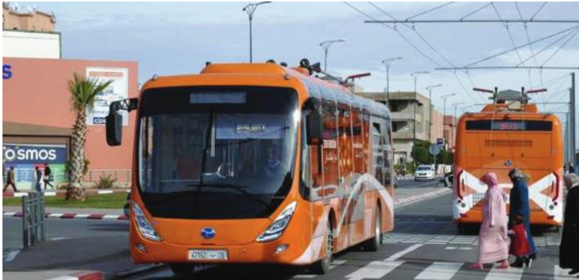
Abbildung 3-35: Yangtse Hybridoberleitungsbus Marrakesh im Batteriemodus [35]
