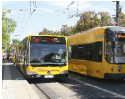
Ebenerdige Einstiegshöhen erleichtern nicht nur den Fahrgastwechsel sondern beschleunigen auch die Haltestellenabfertigung
