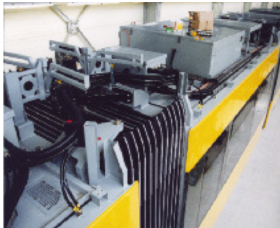
Bei den Niederflurfahrzeugen befinden sich die elektrischen Komponenten gut belüftet auf dem Wagendach
