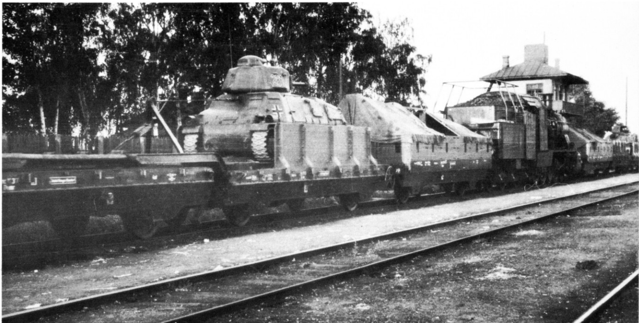
Die für den Rußland-Feldzug aufgestellten behelfsmäßigen Breitspur-Panzerzüge, die nur aus Panzerträgerwagen mit absetzbaren französischen Beutepanzern Somua S 35, oben offenen Infanteriewagen und einer lediglich führerhausgepanzerten Lokomotive der Baureihe 57 bestanden. Oben der Panzerzug Nr. 26 (HGr.Nord), unten der Panzerzug Nr. 28 (HGr. Mitte). (1 x SA, 1 x BA)
