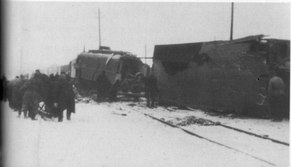
Oben: Ein Rohrkrepiierer zerriß beim Panzerzug Nr. 67 nicht nur den Lauf der 7,62-cm-F.K. 295/1(r), sondern sprengte auch den Panzerturm. Unten: Nachdem der Panzerzug Nr. 1 vorher schon im Kampfeinsatz beschädigt worden war, traf ihn am 10. 12. 1942 in Wjasma auch noch eine Bombe. Daraufhin erfolgte sein Neubau im RAW Königsberg. (SA)
