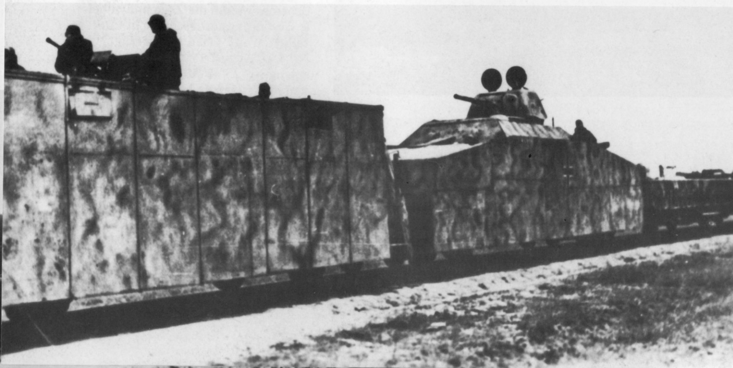
Oben: Der im Frühsommer 1942 von der 83. I.D. aufgestellte Streckenschutzzug trug die Divisions-Nummer als Bezeichnung. Er führte zwei Panzerwagen mit Türmen des russischen Panzers BT-7 (4,5-cm-KwK) und überlebte bis Anfang Mai 1945. (HE)
